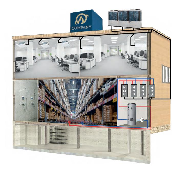
Gli idromoduli necessari sono posizionati all'interno di un locale predisposto (centrale termica) e utilizzano i circolatori presenti al loro interno per spingere l'acqua in un serbatoio di accumulo, che funge da separatore idraulico tra il circuito primario, composto dagli HMU e il secondario, costituito dall'impianto di distribuzione verso il magazzino con pannelli radianti a pavimento.
