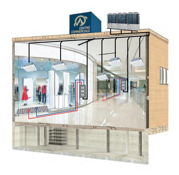
Gli idromoduli sono dislocati all'interno del negozio (uno o più in base alla necessità) e ciascuno utilizza il circolatore presente al suo interno per spingere l'acqua direttamente nell'impianto a pavimento.
